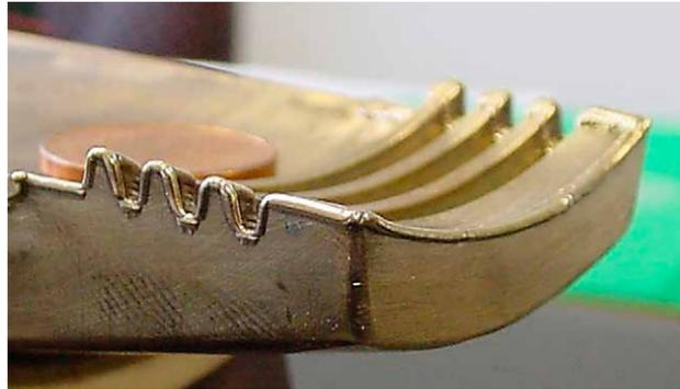
Riparazione dello spigolo di tenuta usurato di un inserto di uno stampo in bronzo Ampco
