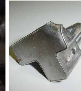
Sul lato di espulsione di uno stampo a iniezione è stata eseguita la saldatura di un bordo eroso
