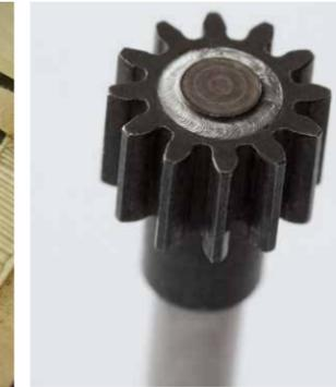
I componenti di un ingranaggio (qui una ruota dentata) vengono montati e saldati garantendo in apporto estremamente ridotto di calore
